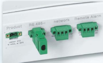
В лабораторных приборах с электронным управлением предусмотрен беспотенциальный контакт для **передачи аварийных сигналов** во внешнюю систему дистанционного предупреждения.
