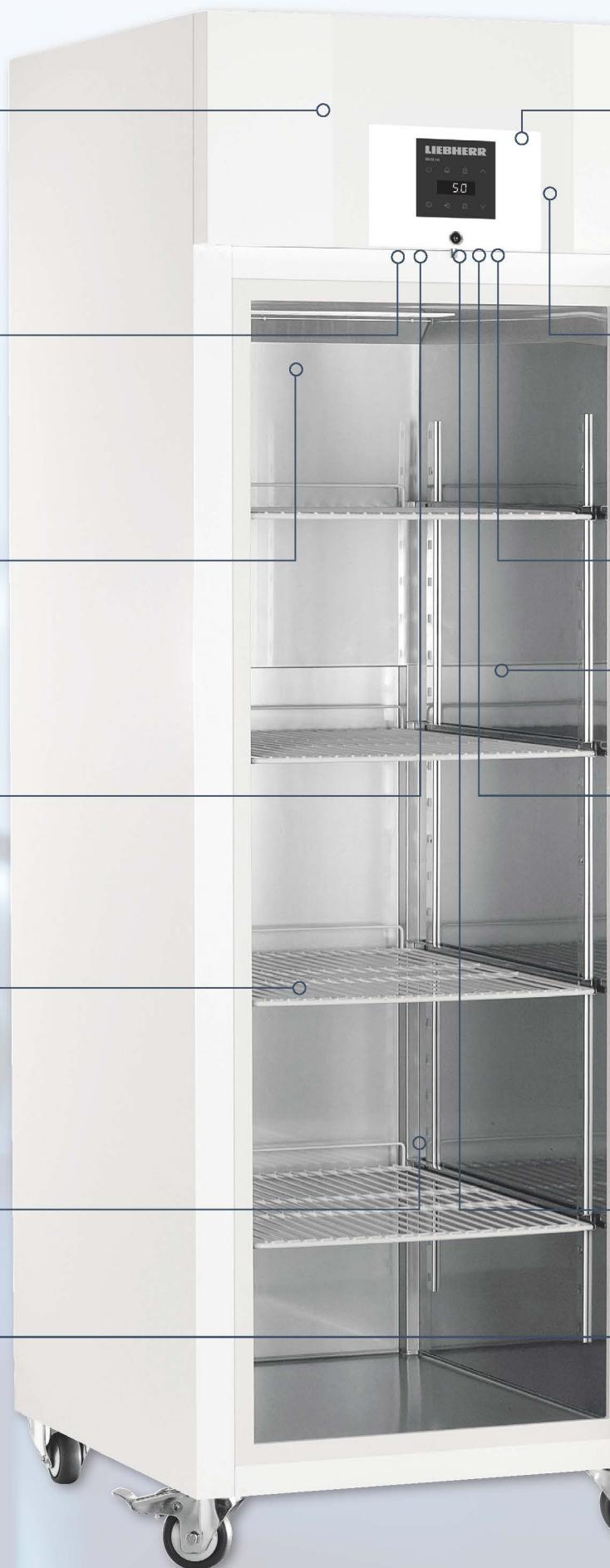
Электронная система управления с многоязычным пользовательским меню и встроенными часами реального времени позволяет задавать **температуру охлаждения с точностью до 0,1°C**.
