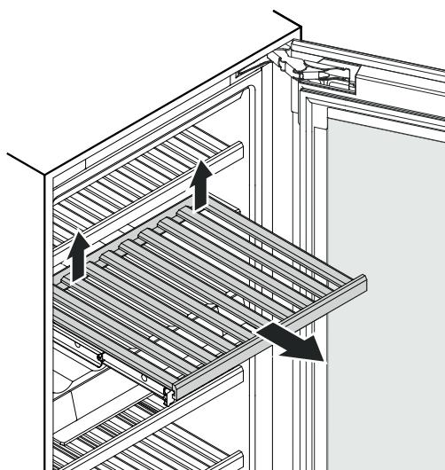
Підніміть дерев'яну полицю в задній частині праворуч і ліворуч угору (виведіть із зачеплення) і, потягнувши уперед, витягніть.
