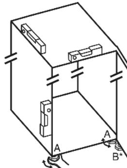
► Після цього підіпріть двері: Витягуйте ніжку на опорному кронштейні (B) до тих пір, поки вона не буде спиратись на підлогу, потім крутіть далі під кутом 90°.
