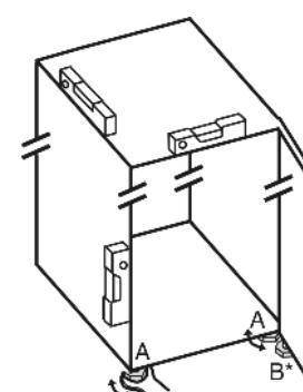
► Після цього підіпріть дверцята: за допомогою ріжкового ключа SW10 викрутчуйте ніжку на опорному кронштейні (B), доки вона не буде опиратись на підлогу, потім поверніть ще на 90°.
