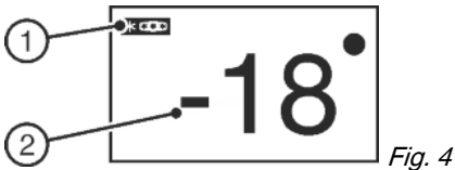
(1) Символ морозильника (2) Індикатор температури морозильника
