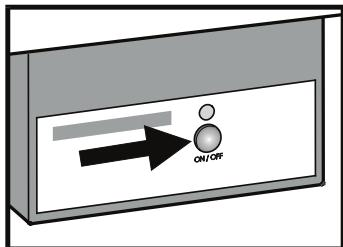
Льодогенератор можна також вмикати і вимкнути кнопкою **ON/OFF** на корпусі льодогенератора.
