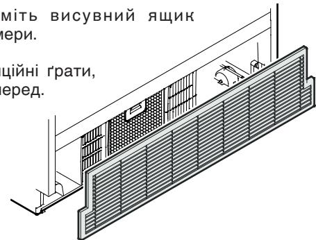
4. Натисніть кнопку на фільтрі, нахиліть фільтр вперед і вийміть його.
